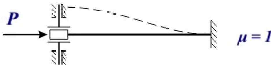
Рис. 18. Коэффициент приведенной длины рассматриваемой конструкции кронштейнов
